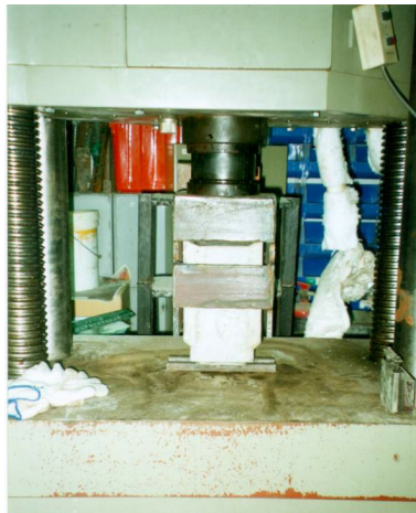
圖 9 100 噸抗壓機進行剪力試驗
