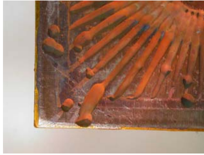
圖 9 casein 塗佈蝕刻不良
