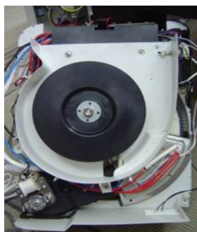
圖 2. 內部的電路設計與風管路徑
