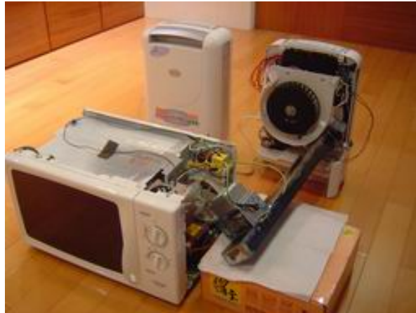
圖 8. 左使用電熱器，右使用微波再生
